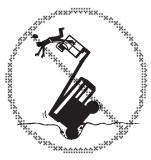
Соблюдайте особую осторожность при перемещении машины в походном положении на неровной поверхности, в развалинах, на неустойчивой или скользкой поверхности, а также рядом с ямами и обрывами.
