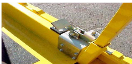
Рисунок 12. Педаля фиксации выдвижной секции.
