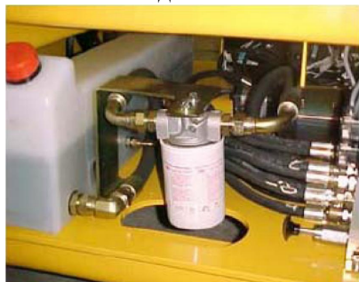
Рисунок 26. Фильтр гидравлической жидкости.
